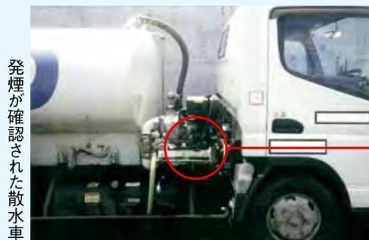
本事案は、6月8日に警察・消防の立会のもと車両発煙箇所の分解調査が行われ、車両に搭載された給排水ポンプ内の機器の一部に焦げ跡が確認されました。
