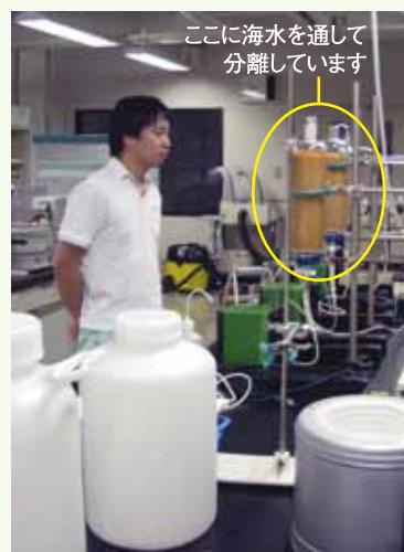
海水中のストロンチウムを分離する装置の進み具合を観察する様子(島根県原子力環境センター)
