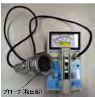
人体や物質の表面に、ベータ線及びガンマ線を放出する放射性物質が付着しているかどうか(汚染の有無)を調べることができます。緊急時の住民避難の際には、住民の身体や衣服に汚染がないか調べるために使われます。使い方は、まず、プローブ(検出部)を身体に向けて左右上下に移動させます。そして針が大きく振れる場所があれば、その付近をゆっくり移動させて値を読み取ります。(右の図)
