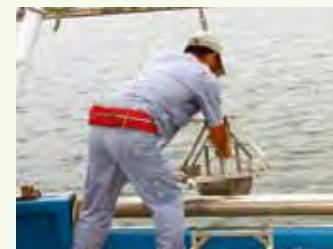
ステンレス製の採泥器具を沈めます
