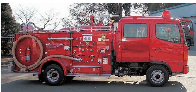
島根原子力発電所に配備される化学消防車のイメージ
