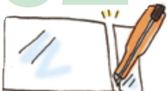
① プラスチック板を、写真より左右上下2cmずつ大きく(15×18cmぐらい)カッターナイフで切る。
