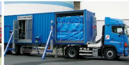
移動式代替熱交換設備
