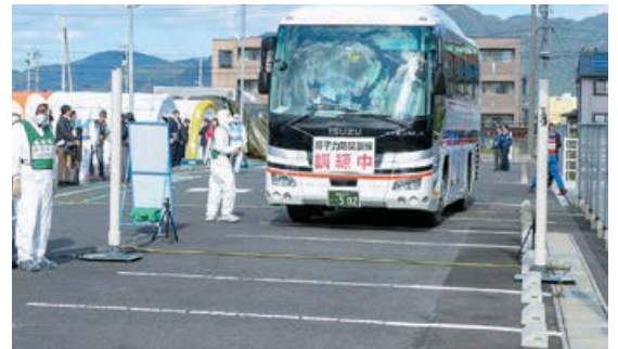
車両用ゲート型モニタを使用した車両検査
